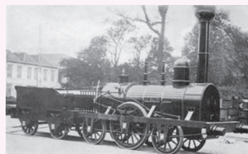
► « Le Belge », première locomotive à voyageurs construite en Belgique (1835).
